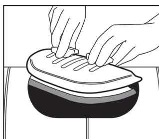
3. Installer la porte en dévissant les boutons jusqu'en haut des vis. A l'aide des deux mains, placez la porte dans le trou.
