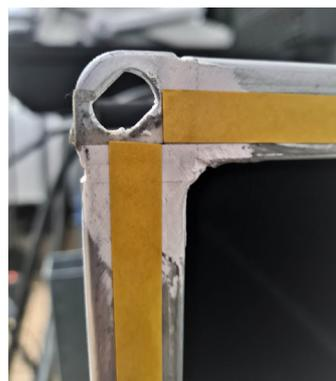
3. Appliquez du ruban adhésif double face sur la face intérieure du cadre. Cela aidera à maintenir le joint en caoutchouc en place lors de l'assemblage du conduit.
