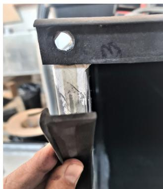
4. Appliquez le joint en caoutchouc avec les petites extrémités du «T» à l'extérieur du conduit.
